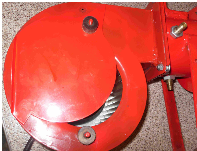
Рис.4 Заслонка вторичного воздуха на горелочном устройстве
