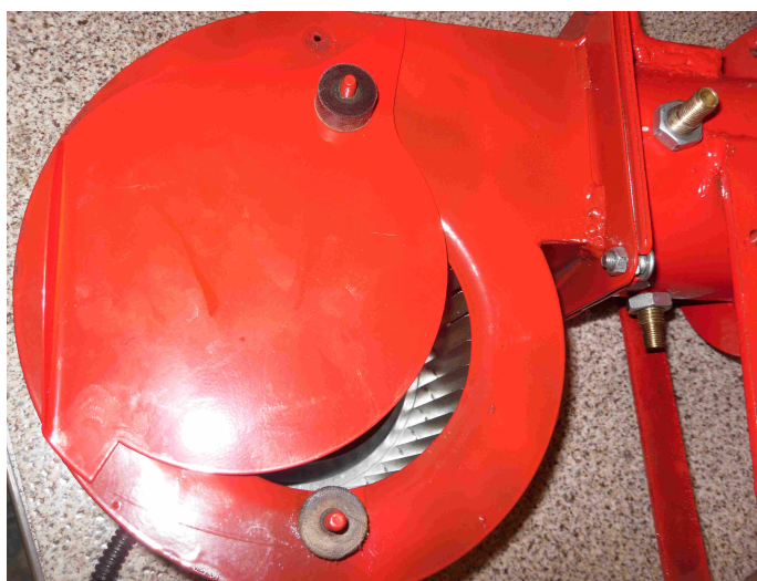
Рис.4 Заслонка вторичного воздуха на горелочном устройстве
